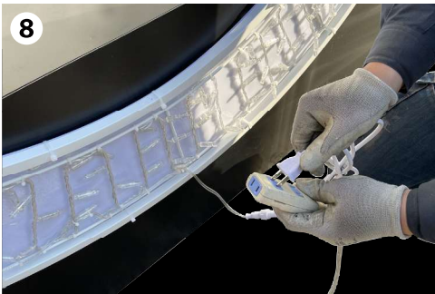
▲ リング本体を付属のパワーコードに連結し、しっかりと固定します。
