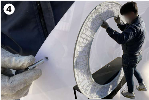
▲ 土台とリングの穴をあわせて、土台をボルトで連結します。
